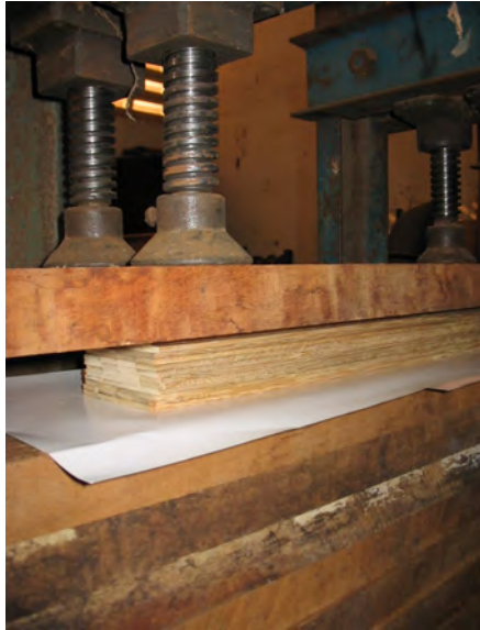
FIGURA 7 - EQUIPAMENTO PARA A COLAGEM EM ESPESSURA DAS RIPAS
